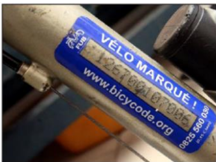
Un poinçon industriel grave dans le cadre, bien en vue, un numéro unique, répertorié dans une base de données. Photo Karim SARI
